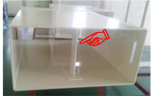
[图 – DUCT 内部加固 图解]
