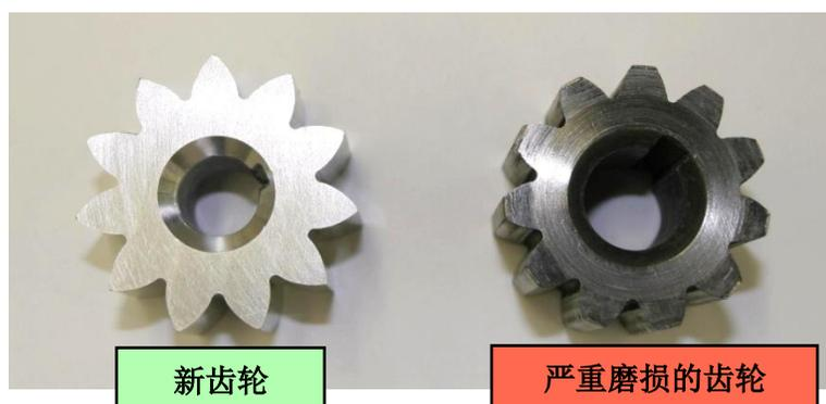
**轴：**根据应用条件及材料选择，长时间使用后轴配合于轴承的部位会磨损（见下图）。可选择经过硬化处理的轴以减小或避免轴表面的磨损。磨损的轴可能会使齿轮与中心泵体接触，从而加速了齿轮和中心泵体的磨损。轴与轴承配合部位应该为圆的且符合磨损允许量表中的最小直径规格。
