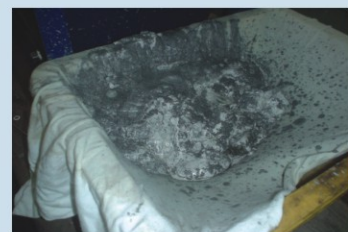
加工機:平面磨床 材質:FC
