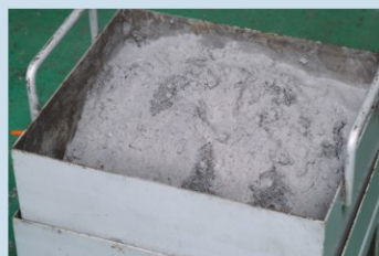
加工機:無心磨床 材質:鋁
